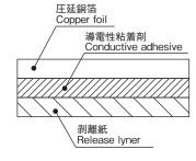
粘着材に導電性フィラーを配合した薄くフレキシブルな金属箔テープ Thin and flexible metal foil tape backed by a conductive filler adhesive
